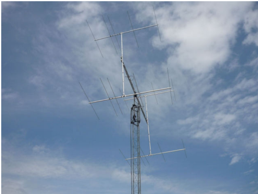
Zestaw antenowy stacji SP3RNZ - 4x yagi 50MHz do łączności EME
